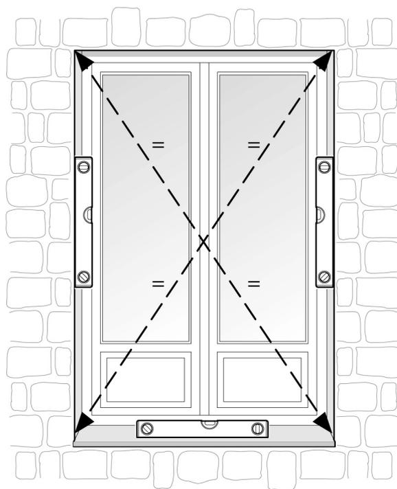
Vérifiez le niveau, l'équerrage et la résistance du support dans lequel vient se fixer le produit. Si des faux niveaux, faux aplombs ou faux équerrages apparaissent, prévoyez d'éventuels calages lors de la pose.
